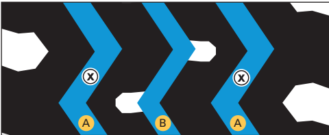
Regrooving width A: 8 - 10 mm; B: 7 - 8 mm
