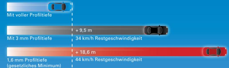
Bremsen aus 80 km/h auf nasser Fahrbahn.\*
